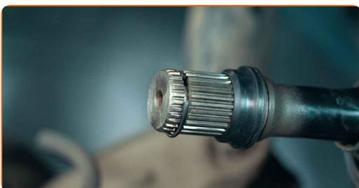
**33** Ajustez la position du circlip de manière à ce qu'il puisse être comprimé par la partie interne du joint lorsque vous exercez une force sur celui-ci
