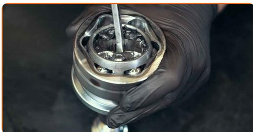
**15** Dégraissez le siège de montage du soufflet de cardan sur l'arbre d'essieu
