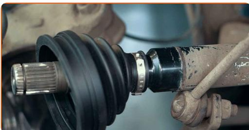
**30** Retournez le soufflet pour éviter de l'enduire de graisse lors de l'installation du joint homocinétique
