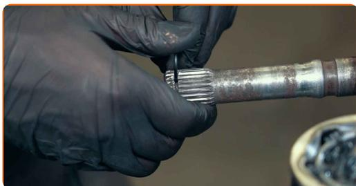
**18** Placez le joint homocinétique sur l'extrémité de l'arbre d'essieu
