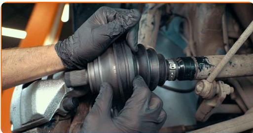
**40** Vérifiez que les colliers de serrage et les soufflets sont correctement positionnés
