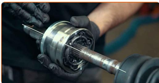
**20** Appliquez de la force sur le boîtier du joint à l'aide d'un tournevis allongé
