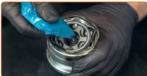
**14** Inclinez le joint dans différentes directions pour répartir le lubrifiant de manière uniforme
