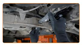
Respectez les couples de serrage recommandés par le fabricant
