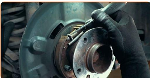
**8** L'accès à l'engrenage de l'ajusteur se fait par le trou du boulon de la roue ou par le trou du moyeu
