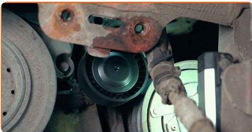
**19** Desserrez le tendeur et installez la courroie trapézoïdale à nervures
