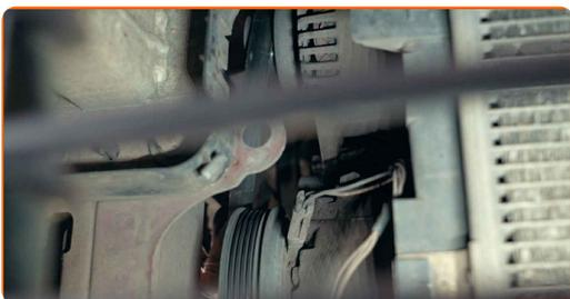
**9** Remettez le mécanisme de tension dans sa position initiale
