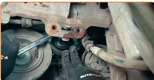
**20** Assurez-vous que la courroie est installée correctement, qu'elle n'est pas mal alignée et que ses nervures sont bien insérées dans les rainures de la poulie
