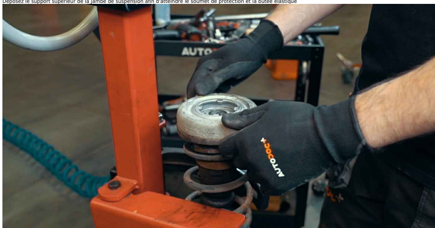
Attention ! • La butée élastique peut être installée sur la tige du piston ou fixée au support • Le soufflet de protection peut être monté sur la butée élastique, installé entre le ressort et le support, ou fixé au support
