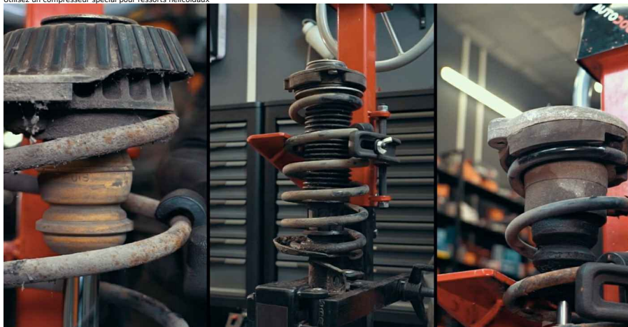
13 Déposez le support supérieur de la jambe de suspension afin d'atteindre le soufflet de protection et la butée élastique
