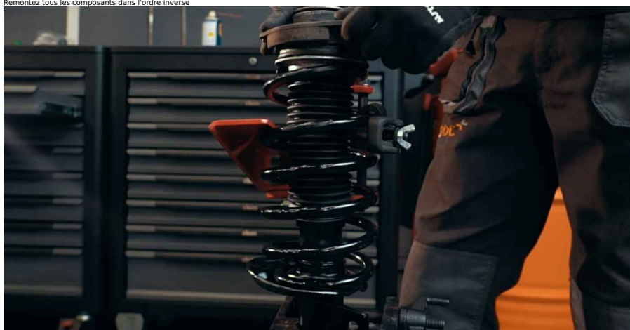
Attention ! • Faites attention à la position du support de jambe de suspension pour vous assurer qu'il est orienté dans la bonne direction
