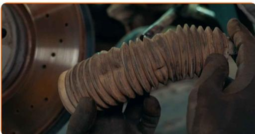
**13** Nettoyez les vieilles traces de graisse et de saleté sur l'arbre de la crémaillère de direction et appliquez de la nouvelle graisse
