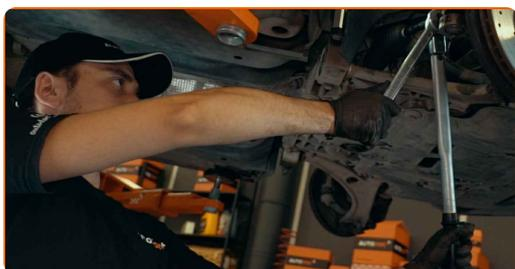
**21** Appliquez un produit anticorrosion sur les fixations
