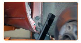
Placez la garniture de passage de roue dans le siège de montage
