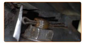
Serrez les fixations inférieures qui relient l'amortisseur à la fusée d'essieu. Utilisez une clé mixte de No.17 Utilisez une douille n° 19. Utilisez une clé dynamométrique. Serrez-le jusqu'à 140 Nm.
