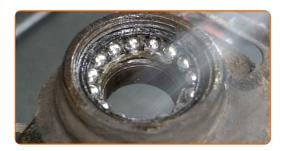
Retirez l'anneau de retenue du palier de moyeu de roue. Utilisez un tournevis plat.
