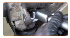
Installez la goupille fendue qui sécurise la fixation connectant le joint à rotule à la fusée d'essieu. Servez-vous d'un pied-de-biche.
