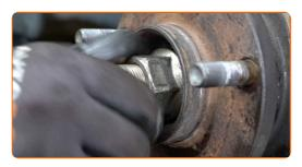
Serrez la fixation connectant le joint à rotule à la fusée d'essieu. Utilisez une clé mixte de No.22 Utilisez une clé dynamométrique. Serrez-le jusqu'à 77 Nm.
