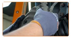
Installez les boulons de fixation.
