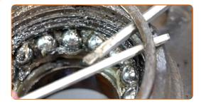
Appuyez pour faire sortir le roulement de moyeu de la roue. Coffret de douilles et de roulements.
