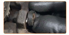
Vissez la fixation reliant le capteur ABS à la fusée d'essieu. Utilisez une douille n° 10. Utilisez une clé dynamométrique. Serrez-le jusqu'à 9 Nm.
