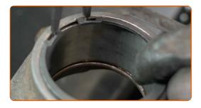
Insérez le roulement neuf dans la fusée d'essieu. Servez-vous d'un coffret de douilles et de roulements.
