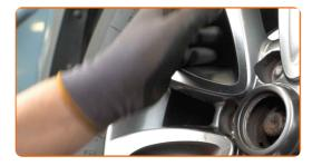
Dévissez les fixations qui lient l'arbre de transmission au moyeu de roue. Utilisez une douille n° 32. Utilisez une clé à cliquet.
