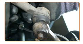
Serrez l'écrou de fixation reliant l'embout de biellette de direction à la fusée d'essieu. Utilisez une douille n° 22. Utilisez une clé dynamométrique. Serrez-le jusqu'à 48 Nm.
