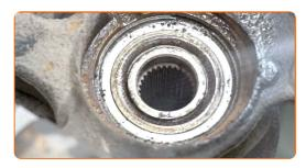
Retirez l'anneau de retenue du palier de moyeu de roue. Utilisez un tournevis plat.
