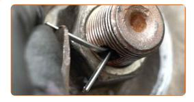
Appliquez du produit sur la fixation de l'essieu homocinétique. Utilisez de la graisse au cuivre.
