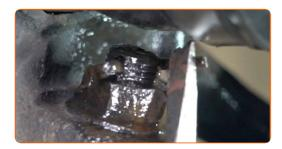
Nettoyez la fixation reliant le joint à rotule au porte-fusée. Utilisez une clé mixte de No.22
