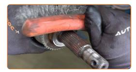
Appliquez du produit sur les cannelures de joint de l'arbre de transmission. Utilisez de la graisse au cuivre.
