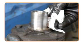
Installez le moyeu de roue sur la fusée d'essieu. Servez-vous d'un coffret de douilles et de roulements.
