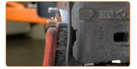
Appliquez du produit sur la zone de contact entre le disque de frein et la jante. Utilisez du lubrifiant céramique.
