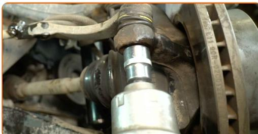
**8** Desserrez le boulon reliant l'embout de biellette de direction à la biellette de direction. Utilisez une douille de 13 mm. Utilisez une clé à cliquet.
