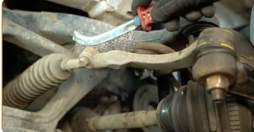
**7** Dévissez l'écrou reliant l'embout de biellette de direction à la fusée d'essieu. Utilisez une douille de 22 mm. Utilisez une clé à cliquet.
