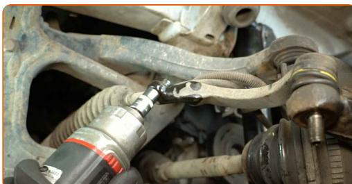
**9** Mesurez et notez la longueur de la partie exposée du filetage de la biellette de direction ou le nombre de tours réalisés par l'embout de biellette de direction lors de son dévissage, afin d'éviter tout désalignement des roues lors du remontage. Utilisez un pied à coulisse.
