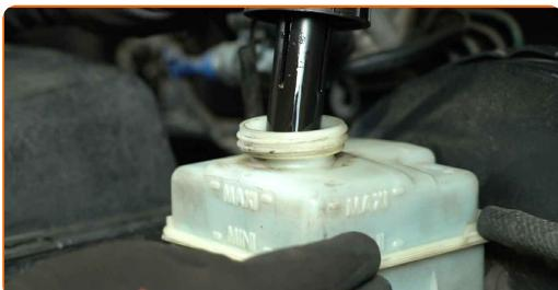
**33** Serrez le bouchon du réservoir de liquide de frein.
