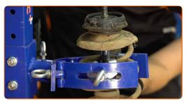
Retirez l'écrou de la tige de piston de l'entretoise. Utilisez la clé HEX n° H6. Utilisez une clé mixte de No.14. Utilisez une clé à cliquet.
