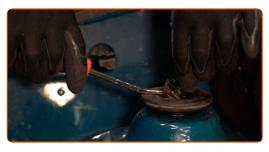
Devissez la fixation supérieure du support d'amortisseur. Utilisez une clé mixte de No.21. Utilisez la clé HEX n° H6. Utilisez une clé à cliquet.
