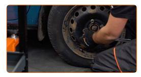
Serrez le montant supérieur de l'entretoise d'amortisseur. Utilisez une clé mixte de No.21. Utilisez la clé HEX n° H6. Utilisez une clé dynamométrique. Serrez-le jusqu'à 62 Nm.
