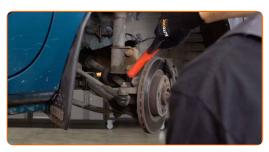
Dévissez la fixation inférieure assurant la connexion entre la jambe d'amortisseur et le porte-fusée. Utilisez une douille n° 21. Utilisez une clé mixte de No.21. Utilisez un porte-taraud.
