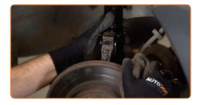
Installez et serrez les nouveaux écrous sur la fusée d'essieu. Utilisez une douille n° 21. Utilisez une clé mixte de No.21. Utilisez une clé dynamométrique. Serrez-le jusqu'à 140 Nm.
