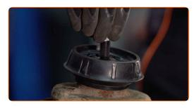
Serrez l'écrou de l'entretoise d'amortisseur due la tige de piston. Utilisez la clé HEX n° H6. Utilisez une clé mixte de No.14. Utilisez une clé dynamométrique. Serrez-le jusqu'à 60 Nm.
