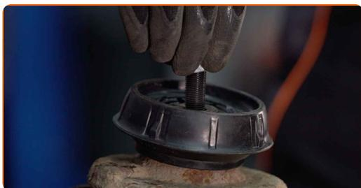
**27** Serrez l'écrou de l'entretoise d'amortisseur due la tige de piston. Utilisez la clé HEX n° H6. Utilisez une clé mixte de No.14. Utilisez une clé dynamométrique. Serrez-le jusqu'à 60 Nm.
