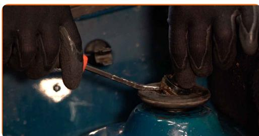
**4** Devissez la fixation supérieure du support d'amortisseur. Utilisez une clé mixte de No.21. Utilisez la clé HEX n° H6. Utilisez une clé à cliquet.
