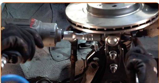
**32** Vissez l'attache du bras avant. Utilisez une clé mixte de No.18 Utilisez une douille n° 18. Utilisez un porte-taraud.
