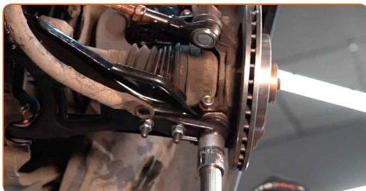
**35** Serrez la fixation avant reliant le bras de commande au sous-châssis. Utilisez une clé mixte de No.18 Utilisez une douille n° 18. Utilisez une clé dynamométrique. Serrez-le jusqu'à 90 Nm.
