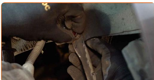
**41** Vissez la fixation du support du renfort de pare-chocs. Utilisez une douille n° 18. Utilisez une clé dynamométrique. Serrez-le jusqu'à 70 Nm.
