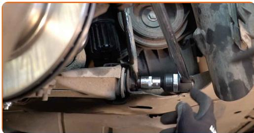
**9** Dévissez les fixations du support du renfort de pare-chocs. Utilisez une douille n° 12. Utilisez un porte-taraud.
