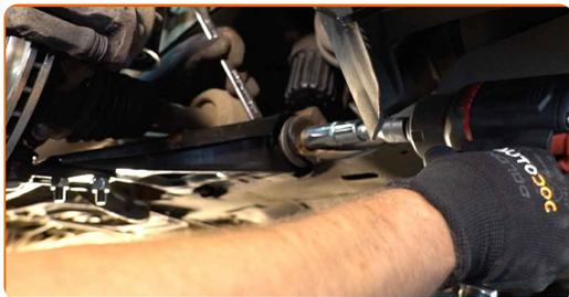
**33** Vissez la fixation arrière reliant le bras de suspension au cadre auxiliaire. Utilisez une clé mixte de No.18 Utilisez une douille n° 18.
