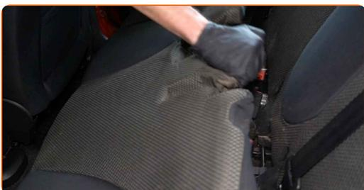
**9** Retirez les protections en plastique des rails du siège arrière. Utilisez un outil d'extraction de clips.
