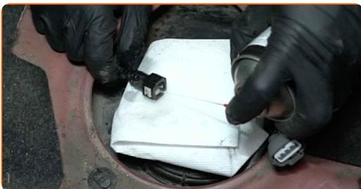
**29** Raccordez la conduite de carburant au module de la pompe à carburant.
