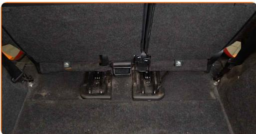
**13** Retirez les protections en plastique des rails du siège arrière. Utilisez un outil d'extraction de clips.
