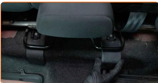
**43** Installez les boulons de fixation.
