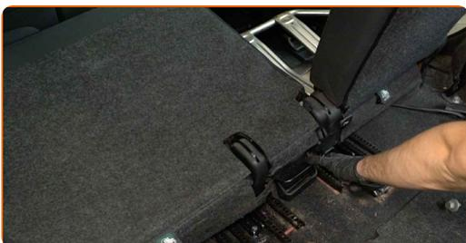
**17** Déplacez les rails du siège arrière sur le côté avec le dossier.
