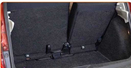
**47** Réinstallez la partie inférieure du siège arrière.
