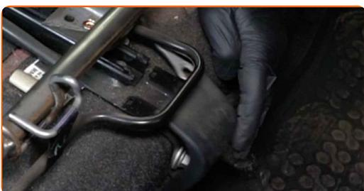
**10** Dévissez les fixations avant des rails du siège arrière. Utilisez une douille n° 17. Utilisez une clé à cliquet.
