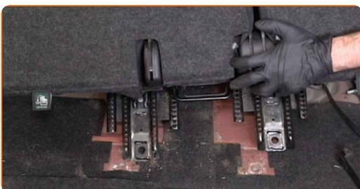
**18** Détachez les fixations du couvercle d'accès au module de la pompe à carburant. Servez-vous d'un tournevis Phillips.
