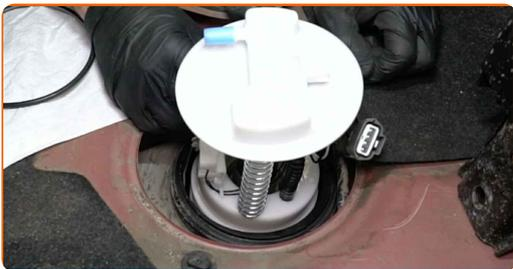
**Remplacement : filtre à carburant – NISSAN Micra C+C III (K12). Conseil :**
