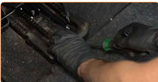
**14** Dévissez les fixations arrière des rails du siège arrière. Utilisez une douille n° 17. Utilisez une clé à cliquet.
