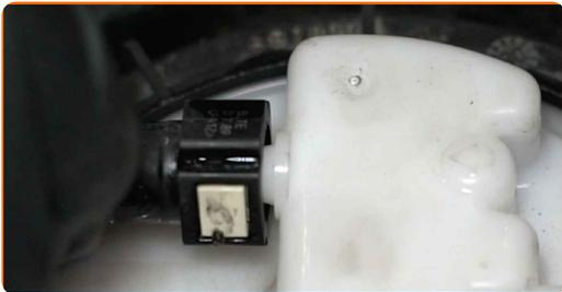
**30** Fixez le connecteur du module de la pompe à carburant.
