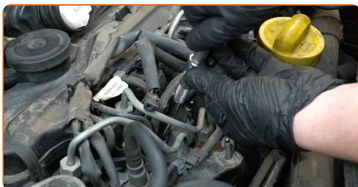
**16** Serrez les bougies de préchauffage. Servez-vous de la douille de bougie d'allumage n°10. Utilisez une clé dynamométrique. Serrez-le jusqu'à 15 Nm.
