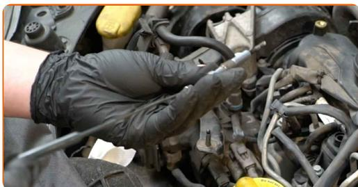
**14** Appliquez du produit sur les bougies de préchauffage. Utilisez la graisse pour injecteurs et bougies de préchauffage.
