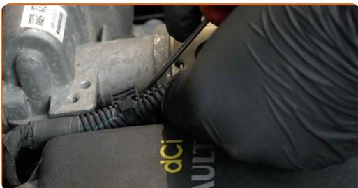
**8** Dévissez les attaches du cache moteur. Utilisez une douille n° 10. Utilisez une clé à cliquet.
