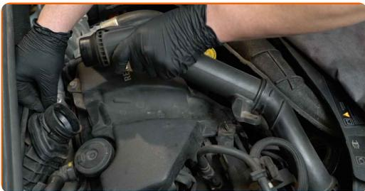
**6** Recouvrez la durite d'admission d'air avec un chiffon microfibre pour empêcher que des particules n'entrent dans le système.
