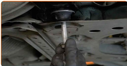
**18** Connectez le joint à rotule à la fusée d'essieu.
