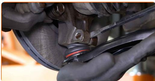
**19** Installez l'écrou de fixation.
