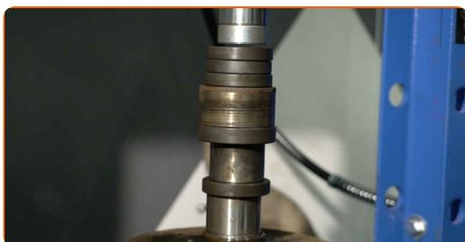
**Remplacement : roulement de roue – NISSAN Note (E11, NE11). Conseil des experts d’AUTODOC :**
