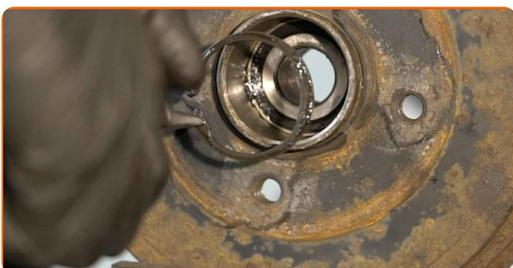
**12** Faites sortir le palier du moyeu de roue. Servez-vous d'un coffret de douilles et de roulements.
