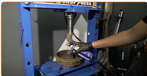
**14** Insérez à la presse le nouveau roulement de moyeu de roue dans le tambour de frein. Servez-vous d'un coffret de douilles et de roulements.
