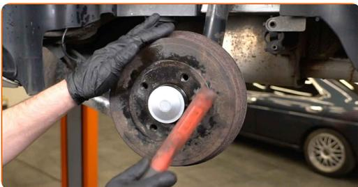
**22** Appliquez du produit sur la surface de contact entre la jante et le tambour de frein. Utilisez de la graisse au cuivre.
