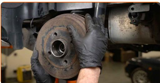
Remplacement : roulement de roue – NISSAN Note (E11, NE11). Les experts d'AUTODOC recommandent :
