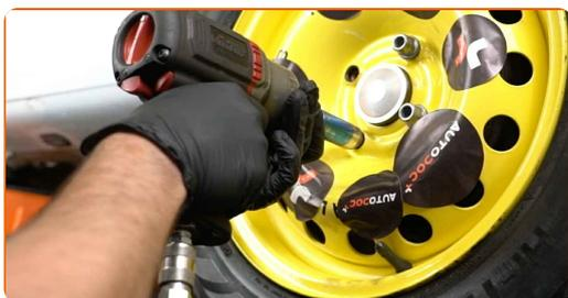
**25** Abaissez la voiture et serrez les boulons de roue en ordre croisé. Servez-vous d'une douille à choc pour roue N°17. Utilisez une clé dynamométrique. Serrez-le jusqu'à 105 Nm.
