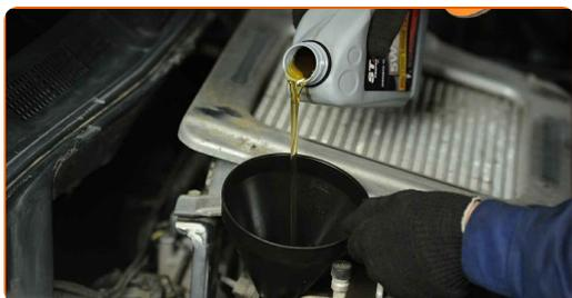
Remplacement : huile moteur et filtre à huile – NISSAN NP300 Navara Pick-up (D23). Les professionnels recommandent :
