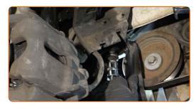
Serrez les fixations des supports de renforcement du sous-châssis. Utilisez une douille n° 13. Utilisez une clé dynamométrique. Serrez-le jusqu'à 35 Nm.
