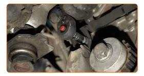
Dévissez la fixation du galet tendeur de la courroie poly-V. Utilisez une clé mixte de No.13
