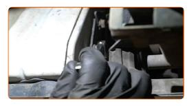
101 Installez le support de l'attache du filtre à carburant.
