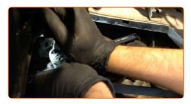
Vissez les fixations du sous-châssis. Utilisez une douille n° 18. Utilisez une clé à cliquet.
