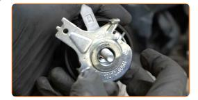
Dévissez les fixations du carter de distribution central. Utilisez une douille n° 8. Utilisez une clé à cliquet.
