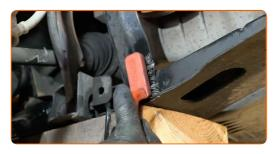
Dévissez les fixations des supports de renforcement du sous-châssis. Utilisez une douille n° 13. Utilisez une clé à cliquet.
