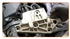
Faites tourner l'engrenage du vilebrequin. Utilisez une douille n° 18. Utilisez une clé à cliquet.
