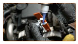
Installez le galet tendeur de la courroie de distribution.
