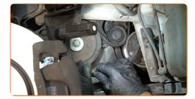
Replacez la poulie du tendeur à sa position initiale. Utilisez une clé mixte de No.16
