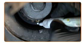
Desserrez la fixation du galet tendeur de la courroie de distribution. Utilisez une clé mixte de No.13 Utilisez la clé HEX n° H6.
