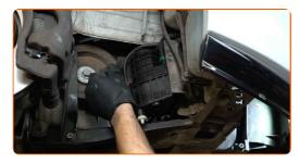
Mettez de côté la poulie de tendeur de la courroie en V crantée. Utilisez une clé mixte de No.16
