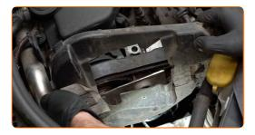
Installez la partie supérieure du support du moteur.
