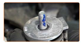
Installez le galet tendeur de la courroie poly-V.
