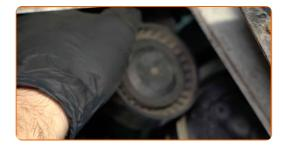
Serrez la fixation du galet tendeur de la courroie poly-V. Utilisez une douille n° 13. Utilisez une clé dynamométrique. Serrez-le jusqu'à 35 Nm.
