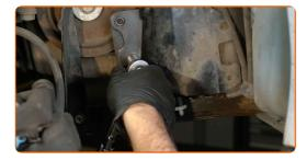
Retirez le support de l'attache du filtre à carburant.
