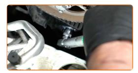
75 Appliquez du produit sur les fixations du support moteur. Utilisez un enduit.
