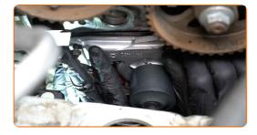
Serrez les fixations de la pompe à eau. Utilisez une douille n° 8. Utilisez une clé dynamométrique. Serrez-le jusqu'à 12 Nm.
