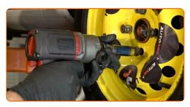
Abaissez la voiture et serrez les boulons de roue en ordre croisé. Servez-vous d'une douille à choc pour roue N°17. Utilisez une clé dynamométrique. Serrez-le jusqu'à 105 Nm.
