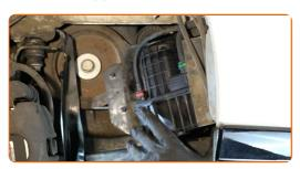
Vissez le boulons de fixation du support du filtre à carburant. Utilisez une clé mixte de No.10
