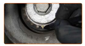
Installez l'outil de blocage de l'engrenage de l'arbre à cames selon les repères d'usine. Utilisez un ensemble d'outils de synchronisation du moteur.
