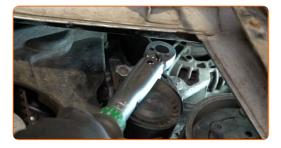
Dévissez la fixation de la poulie de vilebrequin. Utilisez une douille n° 18. Utilisez une clé à cliquet.
