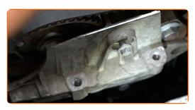
Serrez les écrous de fixation du support moteur. Utilisez une douille n° 10. Utilisez une clé dynamométrique. Serrez-le jusqu'à 40 Nm.
