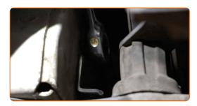
Retirez le support de l'attache du filtre à carburant.
