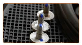
Serrez la fixation supérieure du support moteur. Utilisez une douille n° 16. Utilisez une clé dynamométrique. Serrez-le jusqu'à 76 Nm.
