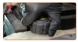
Vérifiez le niveau du liquide de refroidissement. Rajoutez-en jusqu'au niveau requis si nécessaire.
