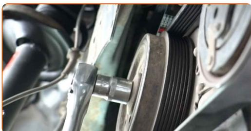
**Remplacement : courroie poly V – NISSAN PRIMERA Hatchback (P12). Conseil d'AUTODOC :**
