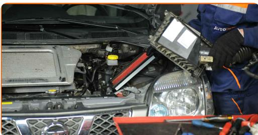
**28** Réinstallez le couvercle du filtre à air. Fixez-le.
