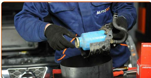
Remplacement : filtre à carburant – NISSAN PRIMERA (P10). Les professionnels recommandent :
