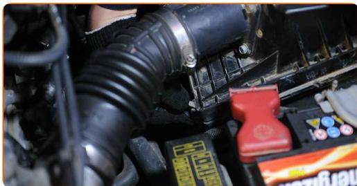
**9** Dévissez les boulons de fixation du support du filtre à air. Utilisez une douille n° 10. Utilisez une clé à cliquet. Servez-vous d'un tournevis Phillips.
