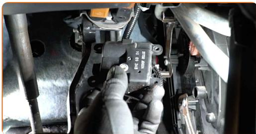
**9** Débranchez le connecteur de l'actionneur de volet de chauffage.
