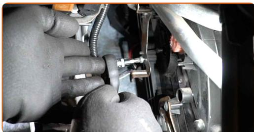
**11** Retirez le support de l'actionneur de volet de chauffage.
