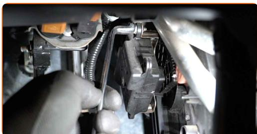
**8** Retirez l'actionneur de volet de chauffage.
