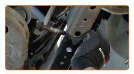
13 Retirez l'écrou de fixation.
