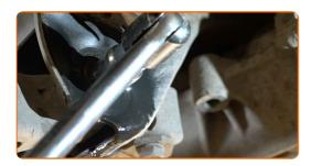
Dévissez la fixation reliant le bras de contrôle à l'essieu arrière. Utilisez une clé mixte de No.18 Utilisez une douille n° 21. Utilisez une clé à cliquet.
