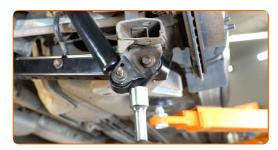
Serrez la fixation reliant le bras de suspension à l'essieu arrière. Utilisez une clé mixte de No.18 Utilisez une douille n° 21. Utilisez une clé dynamométrique. Serrez-le jusqu'à 150 Nm.
