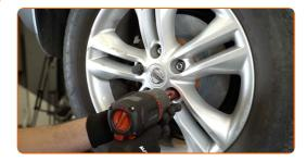
Abaissez la voiture et serrez les boulons de roue en ordre croisé. Servez-vous d'une douille à choc pour roue N°21. Utilisez une clé dynamométrique. Serrez-le jusqu'à 112 Nm.
