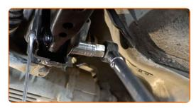
Serrez la fixation reliant la barre stabilisatrice au bras de suspension. Utilisez une clé mixte de No.16 Utilisez une douille n° 18. Utilisez une clé dynamométrique. Serrez-le jusqu'à 88 Nm.
