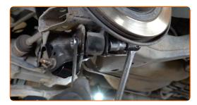
Dévissez la fixation reliant la barre stabilisatrice au bras de suspension. Utilisez une clé mixte de No.16 Utilisez une douille n° 18. Utilisez une clé à cliquet.
