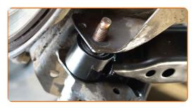
Ajustez la position de l'écrou d'alignement.
