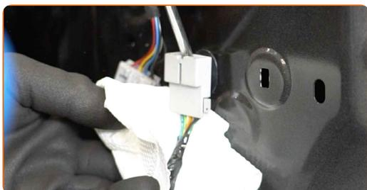
**14** Fixez le connecteur de réglage du rétroviseur à la portière.
