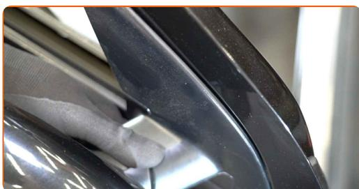
**12** Vissez la fixation du rétroviseur. Utilisez une douille n° 10. Utilisez une clé à cliquet.
