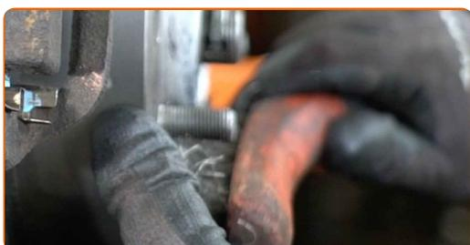
**23** Appliquez du produit sur la zone de contact entre le disque de frein et la jante. Utilisez du lubrifiant céramique.
