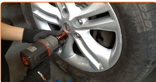
**22** Abaissez la voiture et serrez les boulons de roue en ordre croisé. Servez-vous d'une douille à choc pour roue N°21. Utilisez une clé dynamométrique. Serrez-le jusqu'à 112 Nm.
