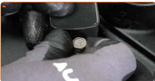
**14** Serrez les fixations des bobines d'allumage. Utilisez une douille n° 10. Utilisez une clé dynamométrique. Serrez-le jusqu'à 9 Nm.
