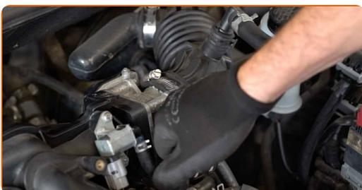
**4** Dévissez les pinces et les fixations sur le tuyau d'admission du filtre à air. Utilisez une douille n° 10. Utilisez une clé à cliquet.
