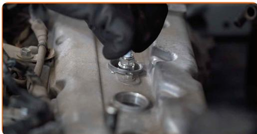
**21** Vissez les nouvelles bougies et serrez-les. Servez-vous de la douille de bougie d'allumage n°16. Utilisez une clé dynamométrique. Serrez-le jusqu'à 19.6 Nm.
