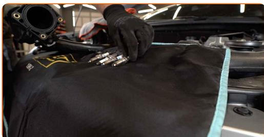
**18** Appliquez une fine couche d'antigrippant à haute température sur les fils des nouvelles bougies d'allumage.
