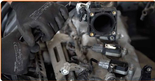
**28** Serrez les fixations du collecteur d'admission. Utilisez une douille n° 10. Utilisez une clé dynamométrique. Serrez-le jusqu'à 27 Nm.
