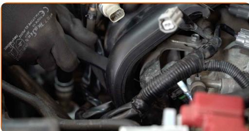
**29** Serrez les fixations du joint d'étanchéité du collecteur d'admission. Utilisez une douille n° 10. Utilisez une clé dynamométrique. Serrez-le jusqu'à 10 Nm.
