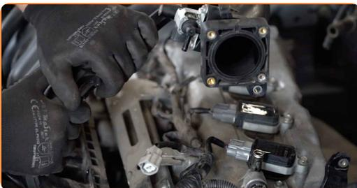
25 Serrez les fixations du collecteur d'admission. Utilisez une douille n° 10. Utilisez une clé dynamométrique. Serrez-le jusqu'à 27 Nm.
