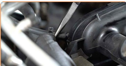
**10** Dévissez les fixations du collecteur d'admission. Utilisez une douille n° 10. Utilisez une clé à cliquet.
