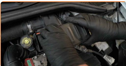
Remplacement : filtre à air – NISSAN TIIDA 3/5 portes. Les professionnels recommandent :
