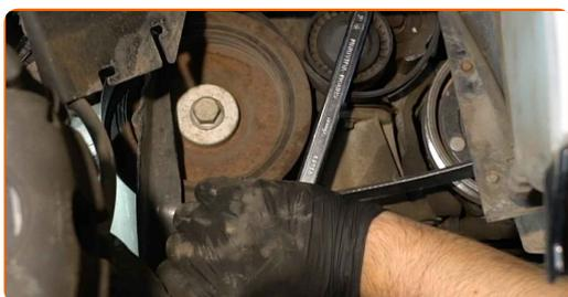
**18** Installez la courroie striée en V sur le tendeur.
