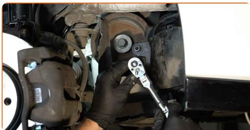
**10** Retirez le support de l'attache du filtre à carburant.
