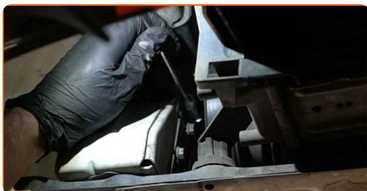
**12** Retirez le support de l'attache du filtre à carburant.
