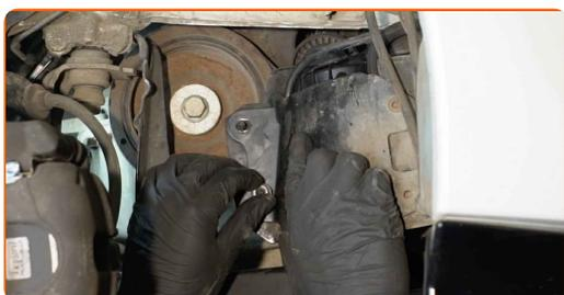
**23** Vissez le boulons de fixation du support du filtre à carburant. Utilisez une douille n° 13. Utilisez une clé à cliquet.
