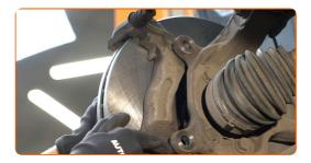
Serrez le support de l'étrier de frein. Utilisez une douille n° 19. Utilisez une clé dynamométrique. Serrez-le jusqu'à 152 Nm.
