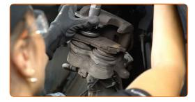
Installez l'étrier de frein et fixez-le. Utilisez une clé mixte de No.17 Utilisez une douille n° 14. Utilisez une clé dynamométrique. Serrez-le jusqu'à 34 Nm.
