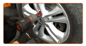
Abaissez la voiture et serrez les boulons de roue en ordre croisé. Servez-vous d'une douille à choc pour roue N°21. Utilisez une clé dynamométrique. Serrez-le jusqu'à 112 Nm.
