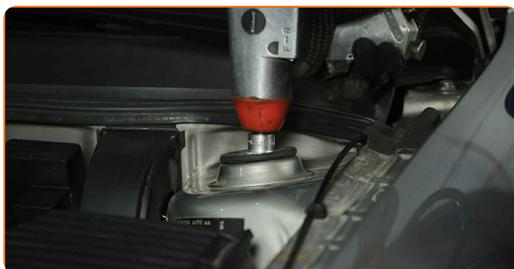
**38** Appliquez du produit sur la fixation supérieure du support de la jambe de suspension. Utilisez de la graisse au cuivre.
