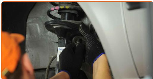
**11** Nettoyez la fixation inférieure reliant la jambe de suspension à la fusée d'essieu. Utilisez une brosse métallique. Servez vous de l'aérosol WD-40.
