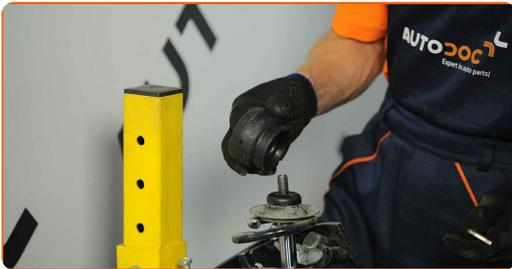
27 Serrez l'écrou de l'entretoise d'amortisseur due la tige de piston. Utilisez une douille n° 20.6. Utilisez la clé HEX n° H6. Utilisez une clé dynamométrique. Serrez-le jusqu'à 60 Nm.
