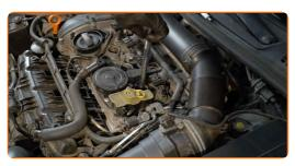
Vissez les nouvelles bougies et serrez-les. Servez-vous de la douille de bougie d'allumage n°16. Utilisez une clé dynamométrique. Serrez-le jusqu'à 27 Nm.
