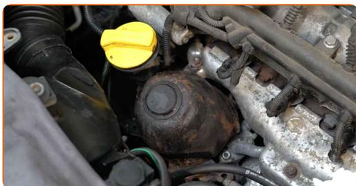
**29** Vissez la protection du boîtier du filtre à huile. Utilisez la mèche Torx T25. Utilisez une douille n° 10. Utilisez une clé à cliquet.
