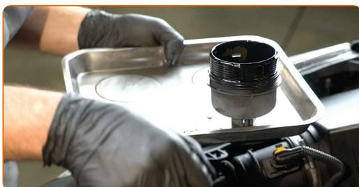
Remplacement : huile moteur et filtre à huile – OPEL Agila B (H08). Les professionnels recommandent :
