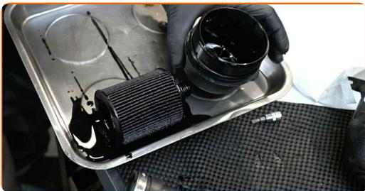
**21** Retirez la bague d'étanchéité du boîtier du filtre à huile. Utilisez un tournevis plat.
