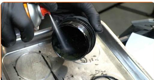
**23** Installez une nouvelle bague d'étanchéité sur l'emplacement du filtre à huile.
