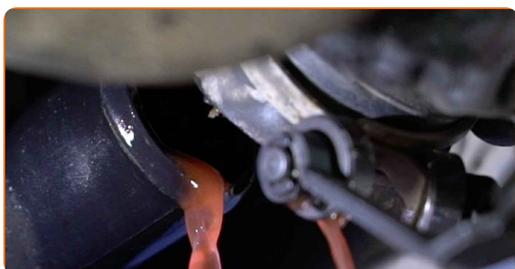
Remplacement : calorstat – OPEL Ascona C CC (J82). Les experts d'AUTODOC recommandent :
