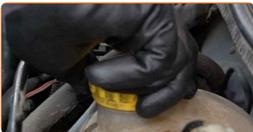
38 Faites tourner le moteur quelques minutes. Cela doit être effectué afin d'éliminer l'air restant dans le système de refroidissement et de vérifier si les composants fonctionnent correctement.
