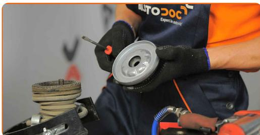
**28** Serrez l'écrou de l'entretoise d'amortisseur due la tige de piston. Utilisez une douille n° 21. Utilisez une clé dynamométrique. Serrez-le jusqu'à 65 Nm.
