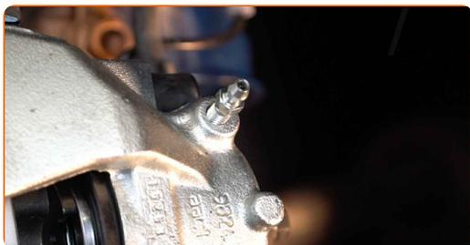
**34** Resserrez la vis de purge de l'étrier de frein. Utilisez une douille n° 8. Utilisez une clé dynamométrique. Serrez-le jusqu'à 11 Nm.
