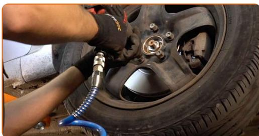
**40** Abaissez la voiture et serrez les boulons de roue en ordre croisé. Utilisez une clé dynamométrique. Serrez-le jusqu'à 110 Nm.
