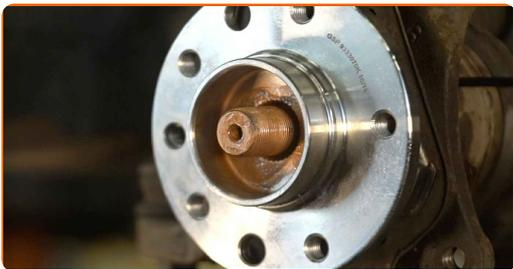
**41** Vissez l'écrou de l'axe de moyeu de roue. Utilisez une douille n° 32.
