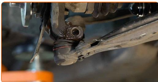
**37** Installez l'écrou de fixation.
