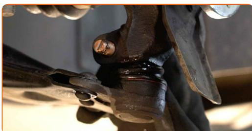
**38** Serrez l'attache du joint rotule. Utilisez une clé mixte de No.17. Utilisez une douille n° 19. Utilisez une clé dynamométrique. Serrez-le jusqu'à 50 Nm.
