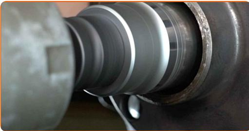
**73** Nettoyez le moyeu. Utilisez une brosse métallique. Traitez la surface de contact. Utilisez du lubrifiant céramique.
