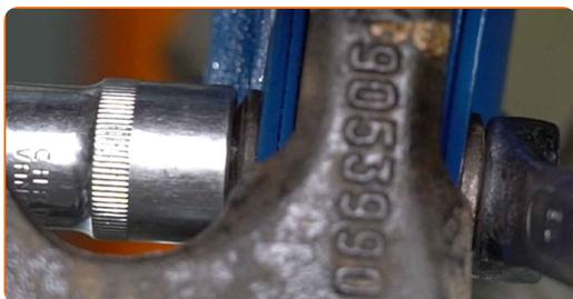
**71** Montez la rondelle du roulement de roue.
