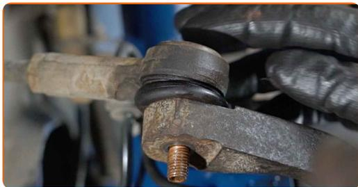
**68** Vissez l'écrou de fixation reliant l'embout de biellette à la fusée d'essieu. Utilisez une douille n° 17. Utilisez une clé à cliquet.
