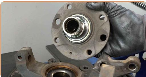
**43** Nettoyez la bague de retenue du roulement de moyeu de la roue.
