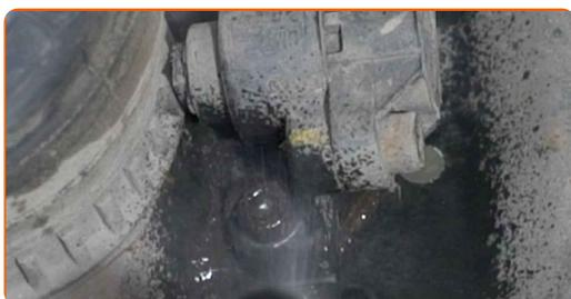
**33** Dévissez la fixation du capteur ABS. Utilisez la clé HEX n° H5. Utilisez une clé à cliquet.
