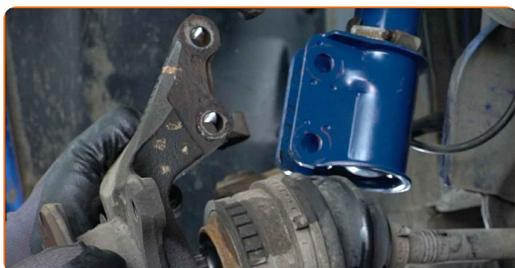
**38** Détachez l'arbre de transmission de la fusée d'essieu.
