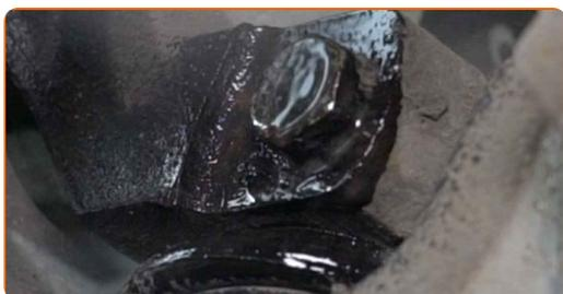
**28** Dévissez l'attache entre le joint rotule et la fusée d'essieu. Utilisez une clé mixte de No.13 Utilisez une douille n° 13. Utilisez une clé à cliquet.
