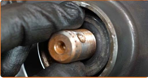
**72** Vissez l'écrou à l'arbre d'entraînement. Utilisez une douille n° 30. Utilisez une clé à cliquet.
