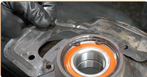
**55** Serrez les fixations de la plaque arrière du disque de frein. Servez-vous d'un tournevis Phillips. Utilisez une clé dynamométrique. Serrez-le jusqu'à 7 Nm.
