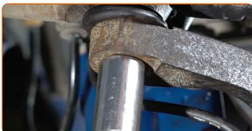
**69** Vissez la fixation reliant le joint à rotule au porte-fusée. Utilisez une clé mixte de No.13 Utilisez une douille n° 13. Utilisez une clé à cliquet.
