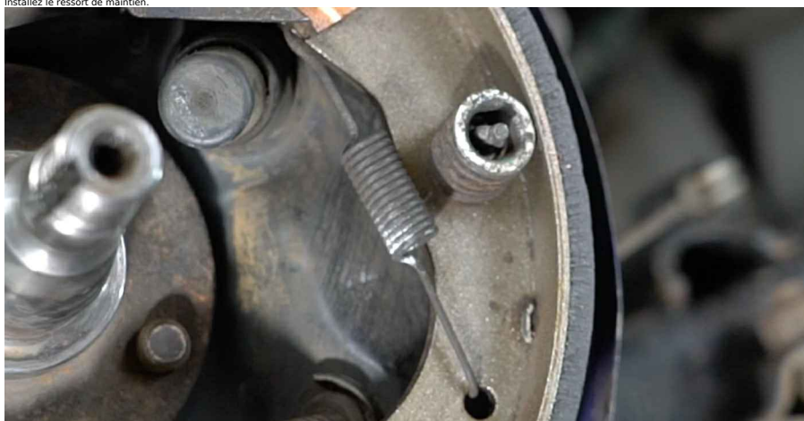
40 Installez le ressort de rappel supérieur. Utilisez des pinces à bec long.
