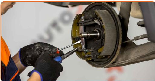
**22** Installez le tambour de frein assemblé avec le roulement du moyeu de roue.
