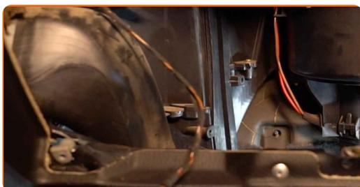
**12** Attachez les fixations reliant le tuyau d'air et le faisceau de câbles au boîtier du filtre à air.
