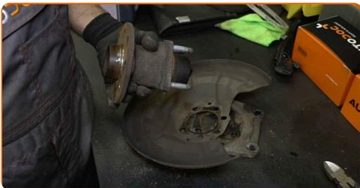
**27** Traitez les attaches du roulement de moyeu de roue. Utilisez de la graisse au cuivre.
