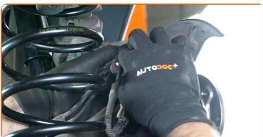
**37** Traitez les attaches du roulement de moyeu de roue. Utilisez de la graisse au cuivre.
