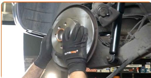
**40** Serrez l'attache du disque de frein. Utilisez la mèche Torx T30. Utilisez une clé dynamométrique. Serrez-le jusqu'à 8 Nm.
