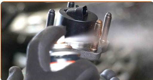
**28** Installez un nouveau roulement de moyeu de roue.
