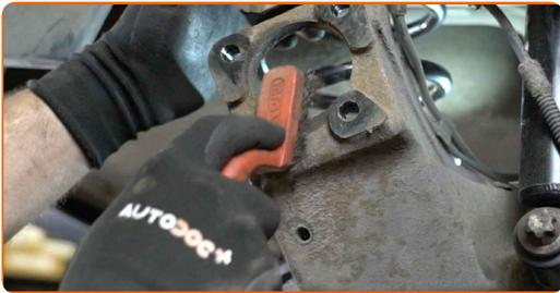
**26** Détachez le roulement de moyeu de la plaque de protection du disque de frein. Servez-vous d'un marteau.
