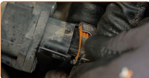
**4** Relâchez le collier de fixation reliant le conduit d'air au boîtier de filtre à air. Servez-vous d'un tournevis Phillips.
