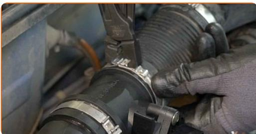
**11** Vissez le collier de fixation reliant le conduit d'air au boîtier de filtre à air. Servez-vous d'un tournevis Phillips.
