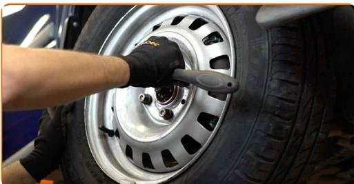
**29** Abaissez la voiture et serrez les boulons de roue en ordre croisé. Utilisez une clé dynamométrique. Serrez-le jusqu'à 110 Nm.
