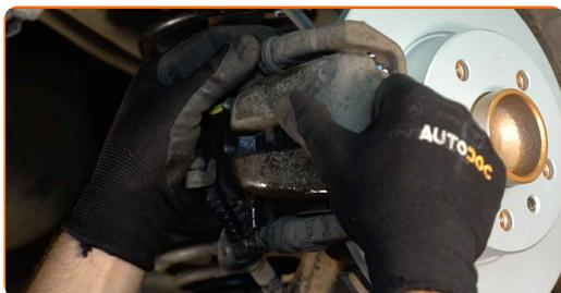
**32** Serrez les fixations de l'étrier de frein. Utilisez une clé mixte de No.17 Utilisez une douille n° 13. Utilisez une clé dynamométrique. Serrez-le jusqu'à 25 Nm.
