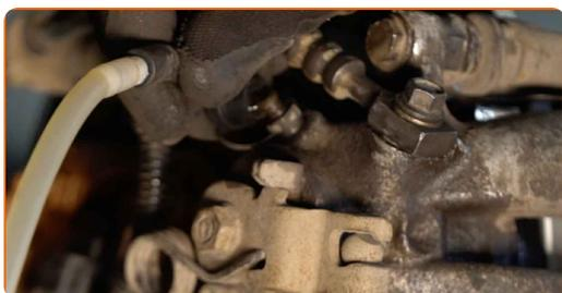
**42** Vissez la vis de purgeur de frein. Utilisez une douille n° 11. Utilisez une clé à cliquet.
