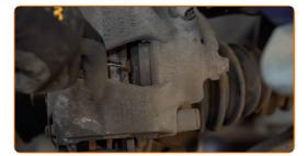
Retirez les bouchons anti-poussière des goupilles de guidage de l'étrier de frein. Utilisez un tournevis plat.
