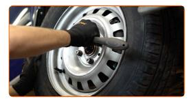
Abaissez la voiture et serrez les boulons de roue en ordre croisé. Utilisez une clé dynamométrique. Serrez-le 30 jusqu'à 110 Nm.
