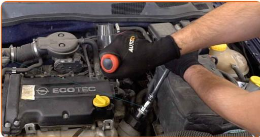
29 Retirez le bouchon du bec de remplissage d'huile.
