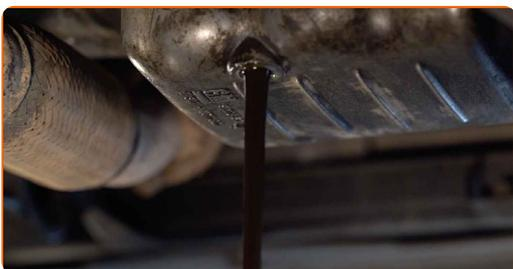
Remplacement : huile moteur et filtre à huile – OPEL Astra H 3/5 portes (A04).
