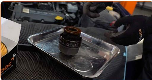
9 Recouvrez le boîtier du filtre à huile avec un chiffon microfibras pour empêcher aux saletés et à tout objet étranger de pénétrer dans le système.
