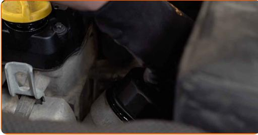
28 Vissez le bouchon. Utilisez une douille n° 32. Utilisez une clé dynamométrique. Serrez-le jusqu'à 15 Nm.
